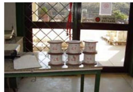
**Foto 2.** Campioni di calcestruzzo preparati per le prove. Si osserva la cattura in miscela di zolfo applicata sulle basi dei campioni per consentire la corretta applicazione del carico durante la prova di schiacciamento.
